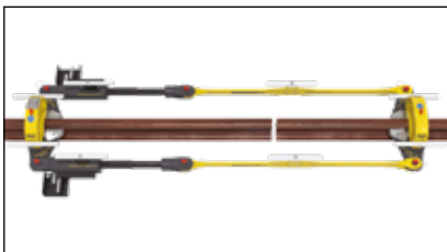
▲ Tensor modular de 70 toneladas que mantiene el riel en longitud neutra durante el proceso de soldadura.
