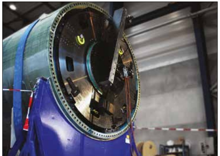
▼ Fresado del extremo del álabes de una turbina con WP3500.
