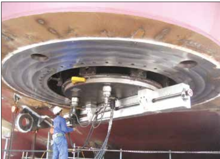
▼ Fresando la brida de una hélice de un barco.
