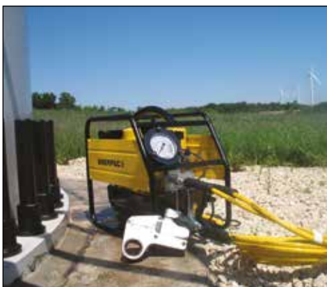
La TQ700E y las llaves dinamométricas de la serie W forman una combinación productiva en aplicaciones eólicas.
