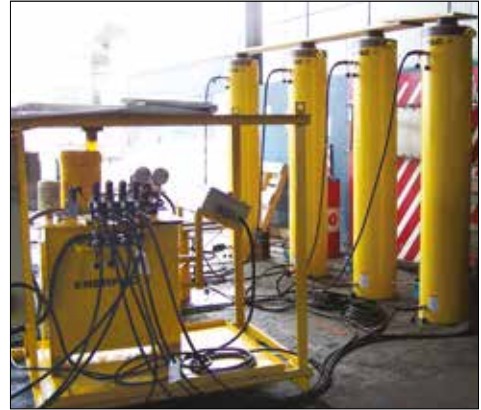
▲ Cilindros personalizados de 500 toneladas con 1,83 m de carrera para la elevación de palas de cuerda eléctricas.
