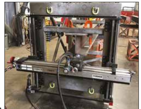
Fresado de cara final de viga I con una GMRF1000. ▶
